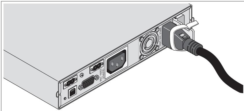
Befestigen Sie das mit der BPS verbundene Netzkabel wie abgebildet.
