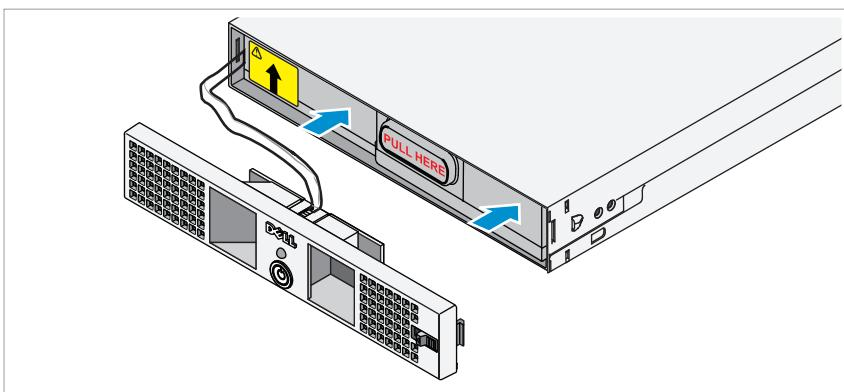
Wyrównaj akumulator względem modułu zasilania i włożyć go ponownie. Upewnij się, że akumulator jest dobrze osadzony w module zasilania. Jeżeli akumulator nie jest dobrze włożony do modułu zasilania, nie będzie można poprawnie założyć pokrywy przedniej akumulatora.
