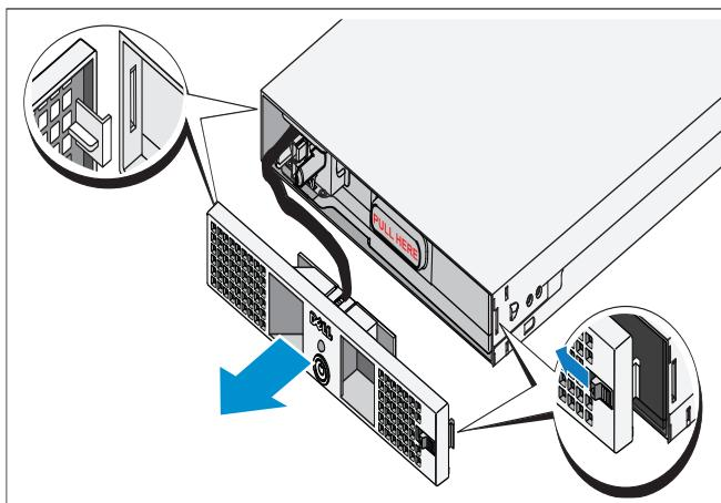
Sur le côté droit du cache avant, faites glisser le loquet vers la gauche afin d'en tirer le crochet. Ce crochet fixe le cache avant au côté droit du châssis. Tirez le côté droit du cache avant à l'écart du châssis. Faites glisser le cache avant vers la droite afin de dégager le crochet. Ce crochet fixe le cache avant au côté gauche du châssis.
