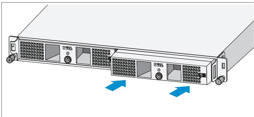
Insérez les modules d'alimentation dans la baie du module de châssis, les panneaux arrière étant tournés vers l'arrière du châssis.
