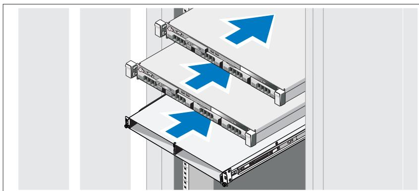
Monte los rieles e instale el sistema y el suministro de energía de repuesto (BPS, por sus siglas en inglés) en el estante. Siga las instrucciones de seguridad y de instalación del estante proporcionadas con la solución.
