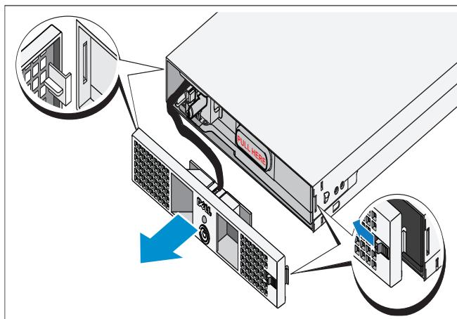
Schieben Sie die Verriegelung auf der rechten Seite der vorderen Abdeckung nach links, um den Verriegelungshaken zurückzuschieben. Der Haken befestigt die Frontverkleidung an der rechten Seite des Gehäuses. Schieben Sie die rechte Seite der vorderen Abdeckung vom Gehäuse weg. Schieben Sie die vordere Abdeckung nach rechts, um den Haken zu lösen. Der Haken befestigt die Frontverkleidung an der linken Seite des Gehäuses.
