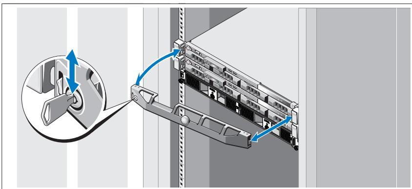
Installieren Sie die Verkleidung für das System (optional).
