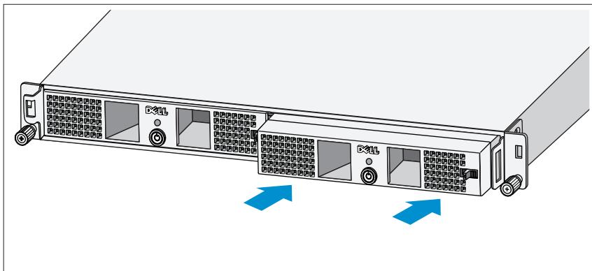
Setzen Sie die Stromversorgungsmodule in den Gehäusemodulschacht so ein, dass die Rückseite der Module zur Gehäuserückseite weist.
