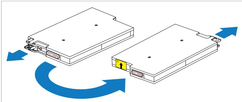
Faites pivoter la batterie de 180° afin que le connecteur permettant un branchement en aveugle soit tourné vers l'arrière du châssis du module d'alimentation.
