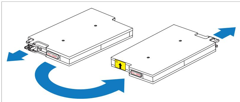
Gire la batería 180° para que el conector pareja ciego se encuentre de cara a la parte posterior del chasis del módulo de alimentación.
