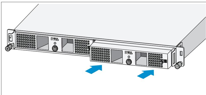
Introduzca los módulos de alimentación en el compartimento para módulos del chasis con los paneles posteriores hacia la parte posterior del chasis.
