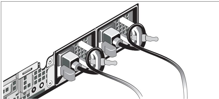
Doble los cables de alimentación del sistema en forma de bucle, como se muestra en la ilustración, y fíjelos a los soportes con la correa proporcionada. Conecte el otro extremo de un cable de alimentación a una toma de corriente con conexión a tierra y el otro cable al BPS. Para obtener más información, ver “Cableado de la solución” en la página 153.
