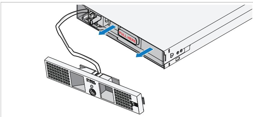
Wyciągnij akumulator z modułu zasilania.
