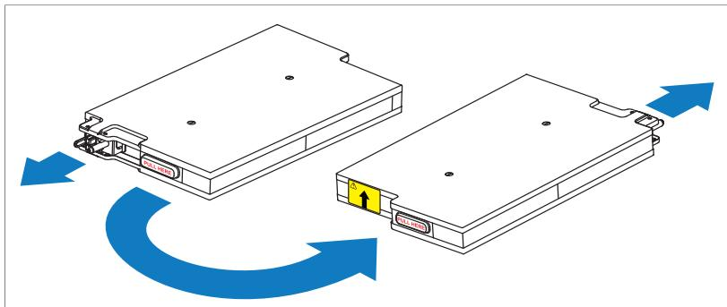
Drehen Sie den Akku um 180 Grad, sodass der Blind-Mate-Anschluss zur Rückseite des Stromversorgungsmodul-Gehäuses weist.
