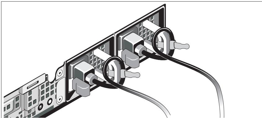
Bilden Sie mit dem(n) System-Netzkabel(n) wie abgebildet eine Schlaufe, und sichern Sie die Kabel mit dem beigefügten Riemen an den Klammern. Stecken Sie das andere Ende des Netzkabels in eine geerdete Steckdose und das andere Kabel in die BPS ein. Weitere Informationen finden Sie unter „Verkabelung der Lösung“ auf Seite 69.
