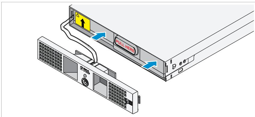
Совместите аккумулятор с модулем питания и вставьте аккумулятор на место. Убедитесь, что аккумулятор полностью размещен в модуле питания. Если аккумулятор не полностью вставлен в модуль питания, передняя крышка аккумулятора не закроется надлежащим образом.
