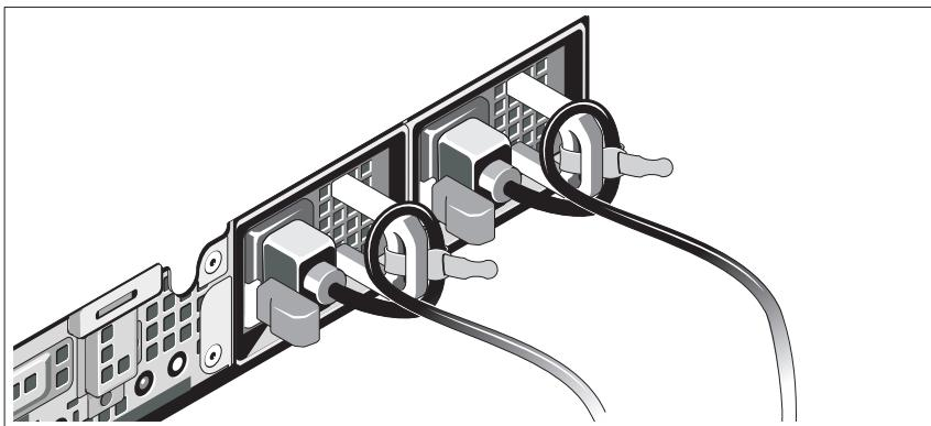
Faites une boucle avec chaque câble (voir l'illustration), puis fixez les câbles à l'aide de l'armature prévue à cet effet. Branchez l'autre extrémité d'un câble d'alimentation à une prise électrique mise à la masse et l'autre câble au BPS. Pour plus d'informations, voir « Câblage de la solution » à la page 49.
