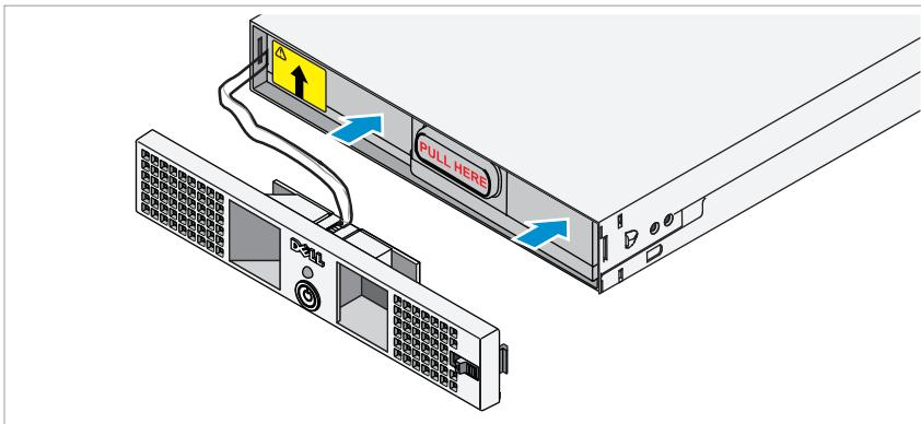
Ευθυγραμμίστε την μπαταρία με το τροφοδοτικό και επανατοποθετήστε την. Βεβαιωθείτε ότι η μπαταρία έχει εφαρμόσει καλά στο τροφοδοτικό. Σε περίπτωση που η μπαταρία δεν έχει εισαχθεί πλήρως στο τροφοδοτικό, το εμπρός κάλυμμα της μπαταρίας δεν θα κλείνει σωστά.
