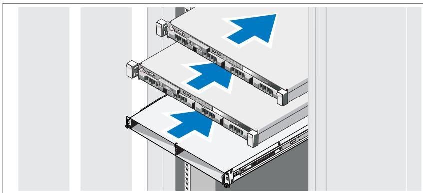
Assemblez les rails et installez le système et le bloc d'alimentation de secours (BPS) dans le rack. Respectez les consignes de sécurité et suivez les instructions d'installation dans le rack fournies avec la solution.
