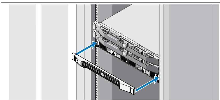
Installieren Sie die Verkleidung für die BPS (optional).
