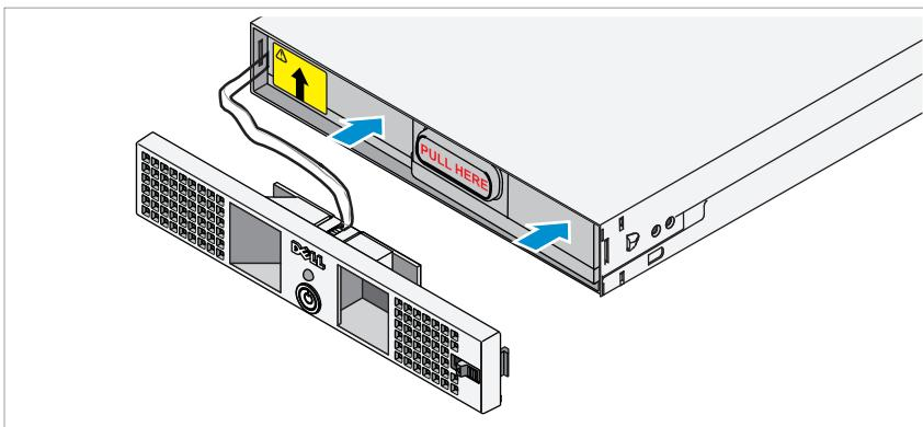
Alignez la batterie avec le module d'alimentation et réinsérez-la. Assurez-vous qu'elle est bien installée dans le module d'alimentation. Si elle n'est pas complètement insérée, son cache avant ne se fermera pas correctement.
