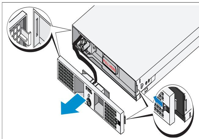
En el lateral derecho de la cubierta anterior, deslice el seguro hacia la izquierda para desengancharlo. El gancho del seguro fija la cubierta anterior al lateral derecho del chasis. Tire del lateral derecho de la cubierta anterior para extraerla del chasis. Deslice la cubierta anterior hacia la derecha para desengancharla. El gancho del seguro fija la cubierta anterior al lateral izquierdo del chasis.
