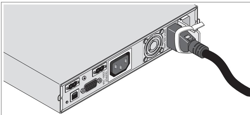
BPS'e bağlanan güç kablosunu çizimde gösterildiği gibi sabitleyin.
