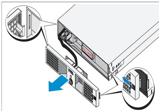
Po prawej stronie pokrywy przedniej przesuń zatrzask w lewo, aby odczepić jego zaczep. Ten zaczep mocuje pokrywę przednią po prawej stronie obudowy. Oddziel prawą stronę pokrywy przedniej od obudowy. Przesuń pokrywę przednią w prawo, aby odłączyć zaczep. Ten zaczep mocuje pokrywę przednią po lewej stronie obudowy.
