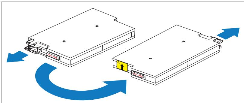
Otočte baterii o  $180^{\circ}$ , aby byl konektor otočen směrem k zadní části šasi zdroje.
