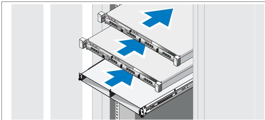
Montieren Sie die Schienen und installieren Sie das System und die Backup-Stromversorgung (BPS) im Rack. Befolgen Sie die Sicherheitshinweise und die mit der Rack-Lösung gelieferten Rack-Installationsanleitung.
