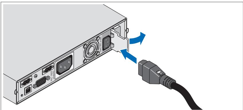
Откройте пружинную крышку взаимоблокировки входного разъема и подключите кабель питания к ИРП.
