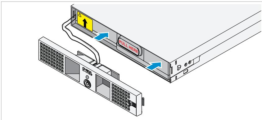
Richten Sie den Akku am Stromversorgungsmodul aus und setzen Sie den Akku wieder ein. Stellen Sie sicher, dass der Akku fest im Stromversorgungsmodul sitzt. Falls der Akku nicht vollständig im Stromversorgungsmodul sitzt, kann die vordere Akku-Abdeckung nicht ordnungsgemäß geschlossen werden.
