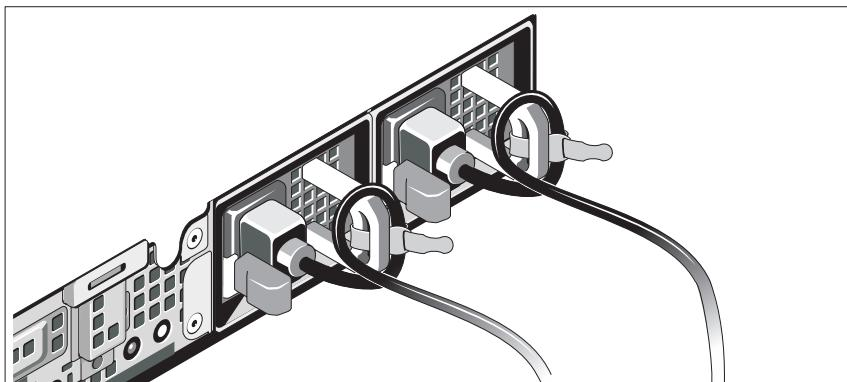
Zegnij kable zasilania systemu w pętlę, jak przedstawiono na rysunku, i zamocuj kabel na wsporniku, używając załączonej opaski. Podłącz drugi koniec jednego kabla zasilania do uziemionego gniazda elektrycznego, a drugi kabel do zasilacza zapasowego. Aby uzyskać dalsze informacje, zobacz „Podłączanie systemu” na stronie 111.
