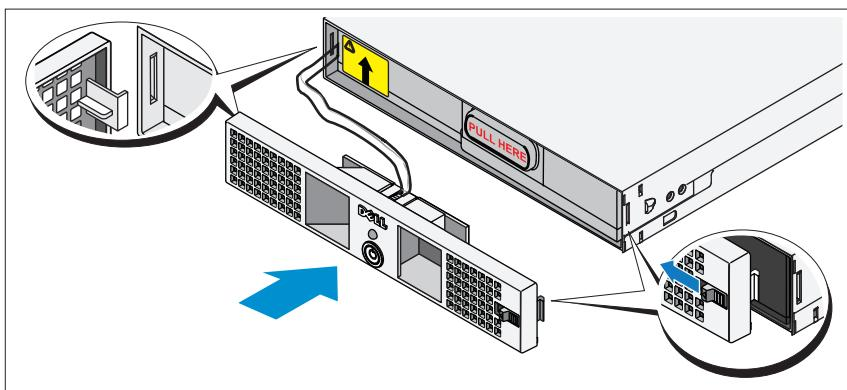
**AVERTISSEMENT :** pour des raisons de sécurité, attachez le cache avant du module d'alimentation dès que le bloc batterie est inséré et connecté.
