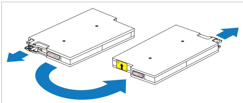
Поверните аккумулятор на 180°, чтобы разъем слепого подключения был направлен в заднюю сторону корпуса модуля питания.
