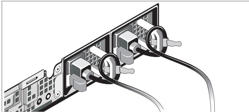
Изогните кабель (кабели) питания системы в форме петли, как показано на рисунке, и прикрепите их к скобам прилагаемой манжетой. Подсоедините другой конец одного кабеля питания к заземленной электрической розетке, а другой кабель — к ИРП. Для получения более подробной информации см. «Подключение кабелей к решению» на стр. 132.
