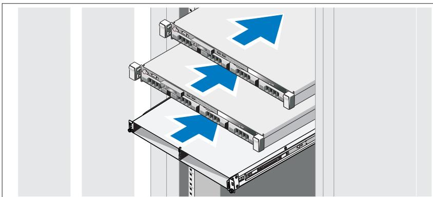
Συναρμολογήστε τις ράγες και τοποθετήστε το σύστημα και την εφεδρική παροχή τροφοδοσίας (BPS) στο rack. Ακολουθήστε τις οδηγίες ασφαλείας και τις οδηγίες εγκατάστασης του rack που στάλθηκαν μαζί με τη μονάδα σας.
