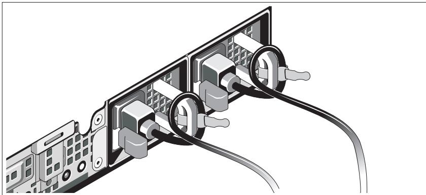
Sistemin güç kablolarnı resimde gösterildiği gibi ilmek yapın ve kabloları sistemle birlikte verilen şeridi kullanarak desteklere sabitleyin. Güç kablolardan birinin diğer ucunu topraklı bir elektrik prizine ve diğer kabloyu BPS'e takın. Daha fazla bilgi için, bkz. "Çözümü Kablolama", sayfa: 172.
