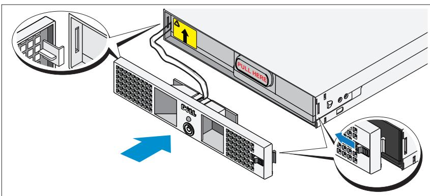
**! OSTRZEŻENIE:** Ze względów bezpieczeństwa zawsze należy zakładać pokrywę przednią modułu zasilania bezpośrednio po włożeniu i podłączeniu zestawu akumulatora.
