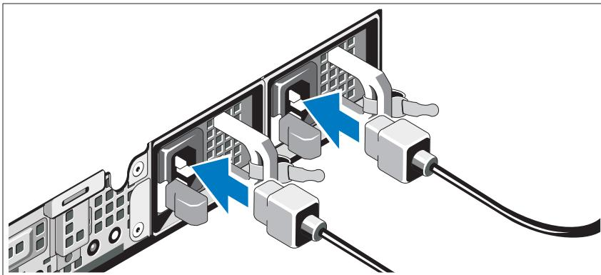
Conecte los cables de alimentación al sistema.
