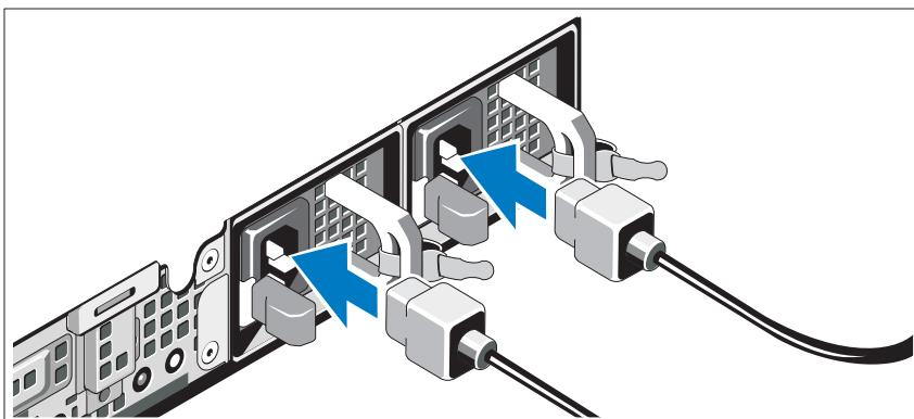
Verbinden Sie das bzw. die Stromversorgungskabel mit dem System.
