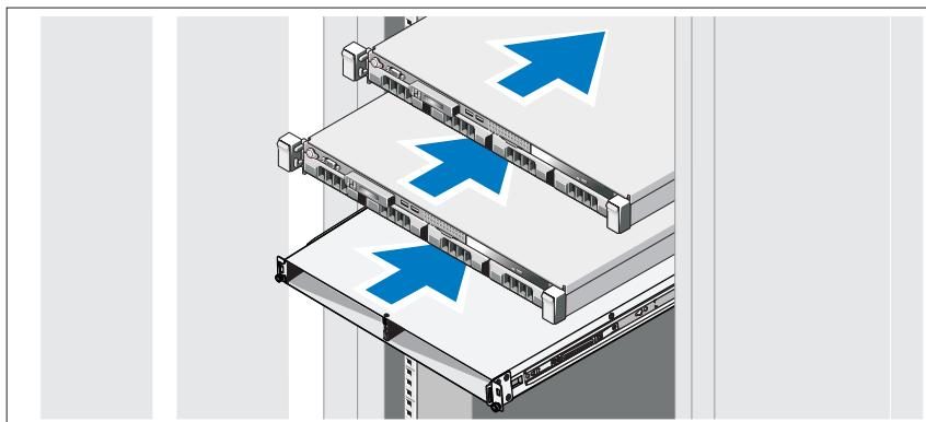
Zamontuj prowadnice i zainstaluj system oraz zasilacz zapasowy w stojaku. Postępuj zgodnie z instrukcjami dotyczącymi bezpieczeństwa oraz instrukcjami dotyczącymi montowania systemów w stojaku dostarczonymi wraz z systemem.
