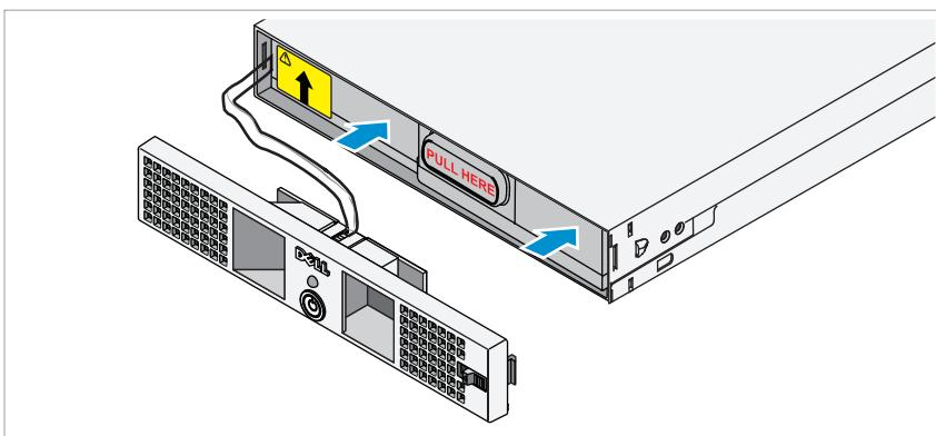
Zarovnejte baterii do modulu zdroje a vložte ji dovnitř. Ujistěte se, že je baterie plně zasazená v modulu zdroje. Pokud baterie není do modulu plně zasazena, nebude možné zavřít přední kryt.
