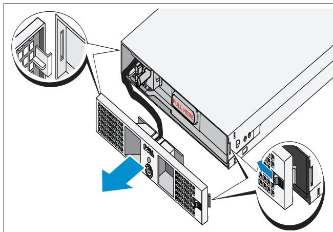
С правой стороны передней крышки сдвиньте защелку влево, чтобы втянуть крючок защелки. Этот крючок прикрепляет переднюю крышку к правой стороне корпуса. Потяните правую сторону передней крышки в направлении от корпуса. Сдвиньте переднюю крышку вправо, чтобы высвободить крючок. Этот крючок прикрепляет переднюю крышку к левой стороне корпуса.
