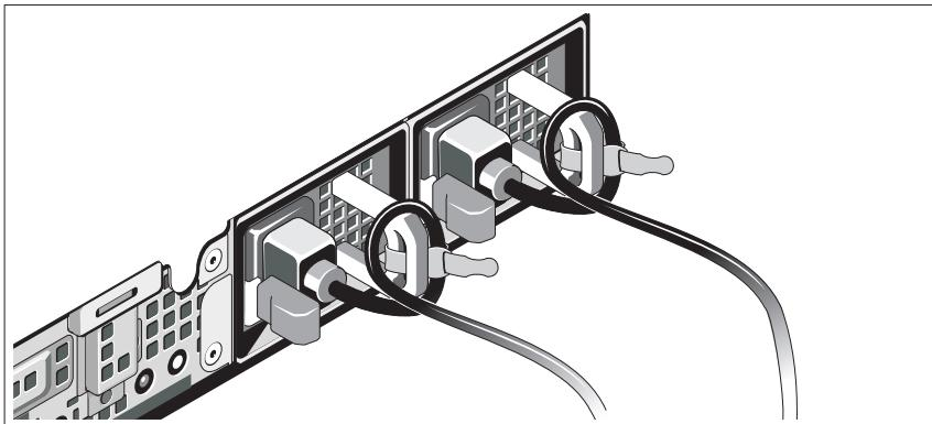
Τυλίξτε τα καλώδια τροφοδοσίας του συστήματος όπως φαίνεται στην εικόνα και στερεώστε τα στα στηρίγματα χρησιμοποιώντας την παρεχόμενη ταινία. Συνδέστε την άλλη άκρη ενός καλωδίου τροφοδοσίας σε μια γειωμένη ηλεκτρική πρίζα και το άλλο καλώδιο στο BPS. Για περισσότερες πληροφορίες, ανατρέξτε στην ενότητα «Καλωδίωση της μονάδας» στη σελίδα 91.
