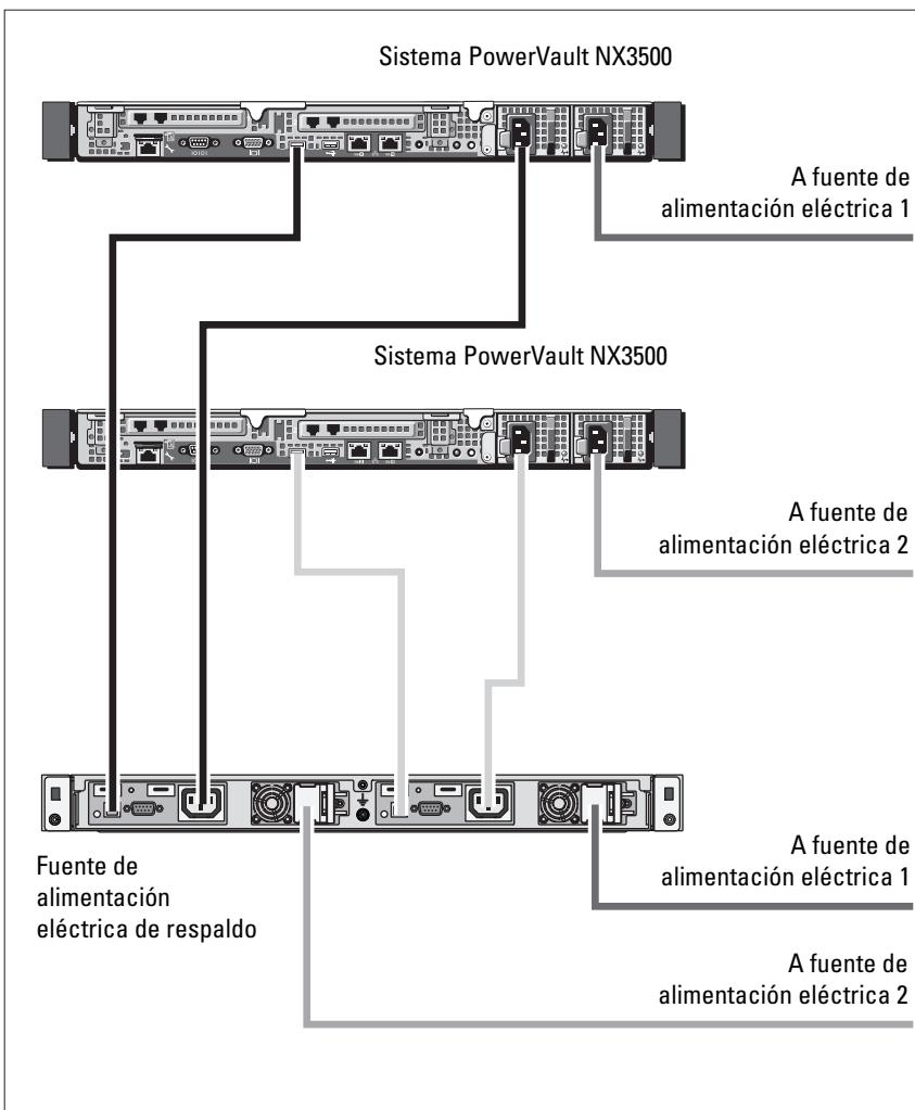
Distribuya los cables de la solución según aparece indicado en la ilustración.
