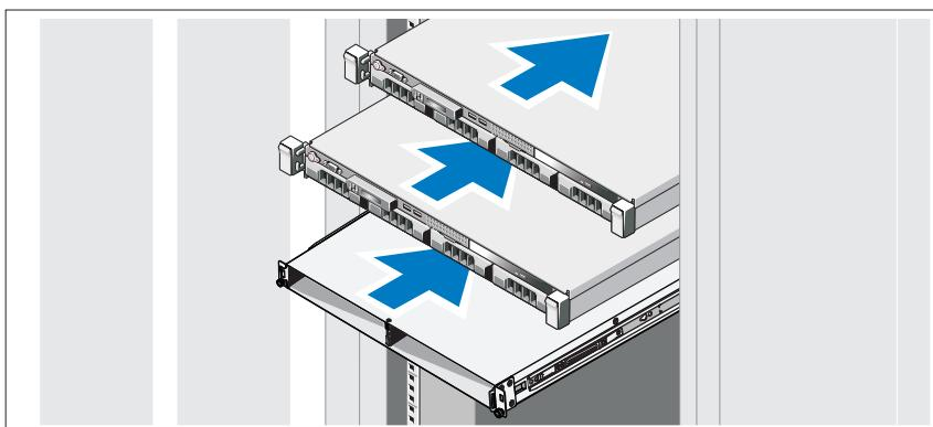
Smontujte kolejnice a namontujte systémový a záložní zdroj (BPS) do stojanu. Říd'te se bezpečnostními pokyny a pokyny pro montáž do stojanu, které byly dodány společně se systémem.
